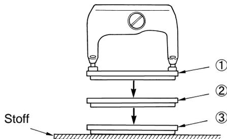
※ Die Höhe der auf der linken Seite beschriebenen Positionen von ① bis ③ kann mit Hilfe der Speicherschalter eingestellt oder geändert werden.
