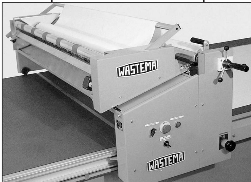
**D**ie Stofflegemaschine **WASTEMA STV 7570** ist ebenfalls universell einsetzbar und zum stangenlosen Legen mit einer motorisch angetriebenen Abwickelmulde – über Tänzerwalze gesteuert – ausgestattet.
