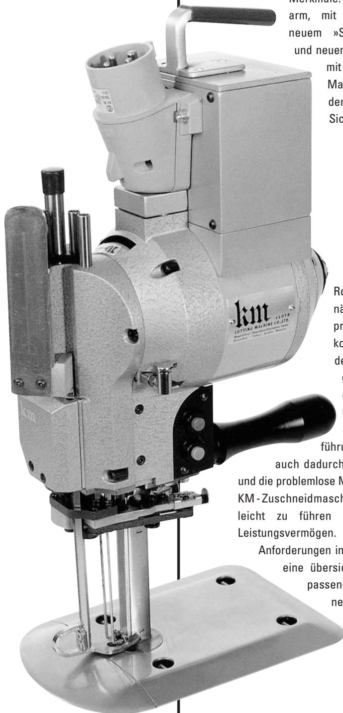
**KM - Zuschneidmaschinen** »beißen« sich durch jede Stofflage, wartungsfrei und unermüdlich. Herausragende Merkmale: besonders vibrationsarm, mit Bandschleifeinrichtung, neuem »Stäbchen-Messerschutz« und neuem Sensor-Sicherheitsgriff mit Elektroniksteuerung. Die Maschine entspricht damit den zur Zeit geltenden Sicherheitsbestimmungen.
