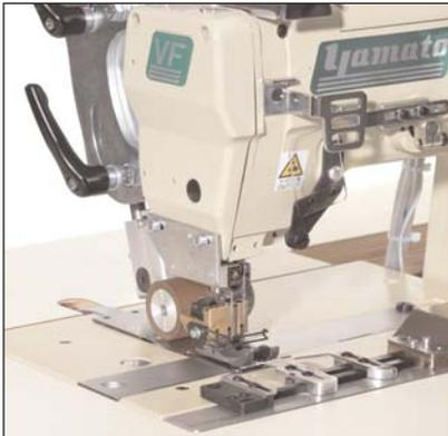
BUSCHE-Arbeitsplatz zum Überstebben der Seiten- und Schrittnähte an Hosen mit der YAMATO VF 2502 - 064.
