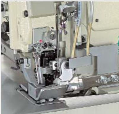
BUSCHE zeigt hier eine schwere 2-Nadel-2-Linien-Doppelkettenstich-Einfassmaschine mit Vorschneider aus der Serie YAMATO AZF 8600 G.
