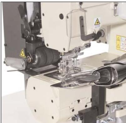
Die YAMATO-Maschine MG 2004 P ist eine 4-Nadel-Doppelkettenstich-Zylinderarm-Nadeltransportmaschine zur Herstellung von Hosenbunden, speziell an Jeans oder Freizeithosen. Die moderne Maschine eignet sich besonders für starke Materialien, hat verstärkte Nähwerkzeuge, einen sicheren Transport, schnell einstellbare Stichlänge, automatische Schmierung und einen Stoffpuller mit unterer Ausgleichswalze. Standard-Nadelbreite ist 31,8 mm oder 34,9 bzw. 38,2 mm als 4-Nadelmaschine.
