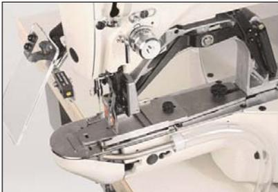
Dieser neue Riegelautomat der Serie LK 1900 ASS hat ein Nähfeld von 40 x 30 mm. Ausgestattet mit aktiver Fadenspannung sowie Greiferfadenklemme, Maximalleistung 3.000 Stiche/Min.
