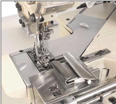
BUSCHE Arbeitsplatz YAMATO VG 2700 Weichbundmaschine als 2-Nadel- oder 3-Nadelmaschine erhältlich. Standard mit Oberlegfadeneinrichtung, Optional ST2A Legefadenschneideinrichtung und UTL-Stichverkotung am Nahtende.
