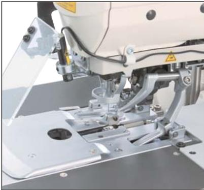
Computergesteuerter Augenknopfloch-Automat mit spezieller Schneideinheit zum Einsatz in den Bereichen HAKA und DOB.
