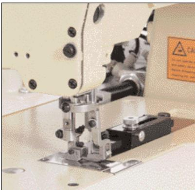
Die neue 1-Nadel-Doppelkettenstich-Flachbettmaschine ist ausgestattet mit Zangenober- sowie Differentialuntertransport, autom. Fadenabschneider und Fußlüftung. Über die neue EFKA-Steuerung AB 425 werden die Schrittmotore für Zangenober- und Differentialuntertransport gesteuert.
