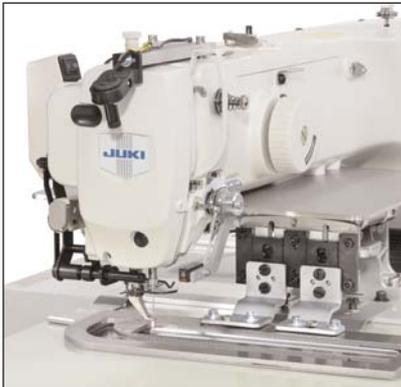
Dieser neue Nähfeldautomat JUKI AMS 221 EH-L mit programmierbarer Schrittmotorsteuerung für die X- und Y-Achse, wurde speziell eingerichtet für das Nähen von Hosenschlitzleisten.
